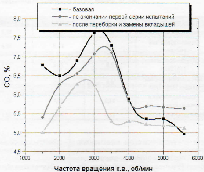
Изменение кривой содержания CO при работе двигателя по ВСХ на различных стадиях испытаний
